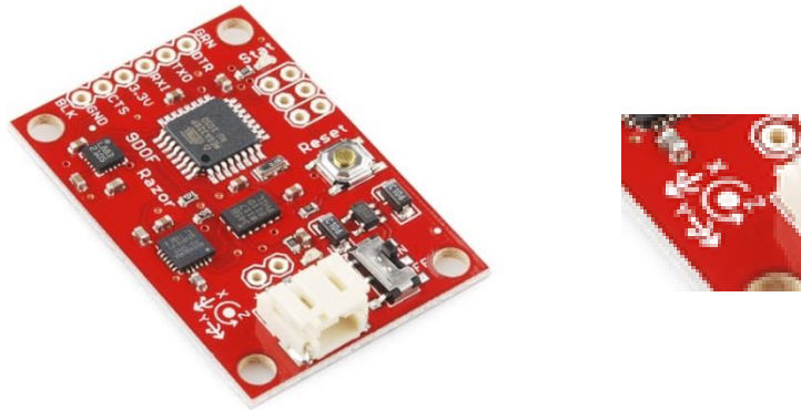
Figura 3-5 IMU Razor 9DOF. Detalhe do sistema de coordenadas considerado para as medições do sensor. Fonte: https://www.sparkfun.com/products/10736 . Acesso em 15/06/2013
